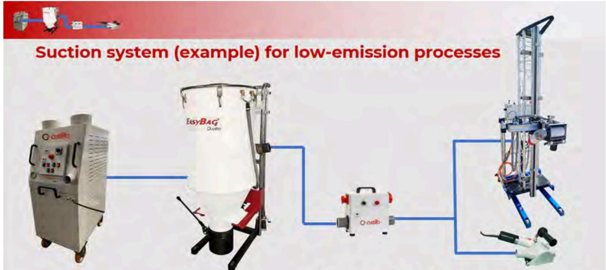
Aspiration et ensachage possible jusqu'à 100m de distance !
