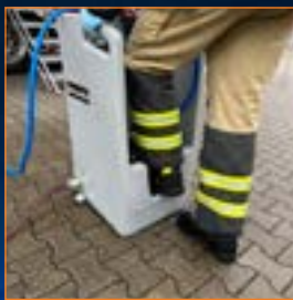
STIEFELWASCH-ANLAGE Reinigen von Stiefeln und Geräten
