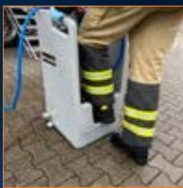
STIEFELWASCH-ANLAGE Reinigen von Stiefeln und Geräten
