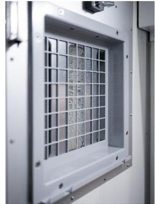
Unterdruckhaltegerät mit HEPA-Filter
