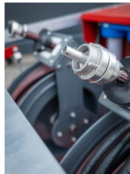
2 Schlauchhaspeln mit Wasser- und Abwasserschlauch
