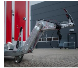
Höhenverstellbare Deichsel mit Wechselkuplung
