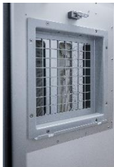
Unterdruckhaltegerät mit HEPA-Filter
