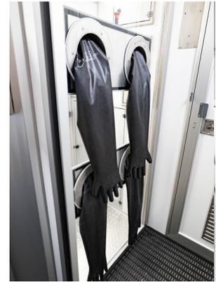
Glovebags zur hygienischen Trennung und sicheren Unterstützung bei der Entkleidung
