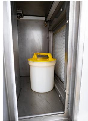
Sichere Proben-ausschleusung über Unterdruck-Schleuse
