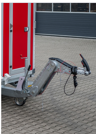
Höhenverstellbare Deichsel mit Wechselkuplung
