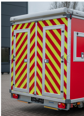
Heckwarnmarkierung und LED Blaulichter
