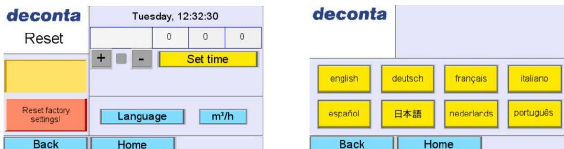
L'unità di misura può essere cambiata in m³/min toccando il pulsante m³/h.
