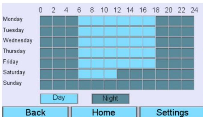
Selezionando gli intervalli di tempo, è possibile stabilire in quali giorni e a che ora viene attivato il valore impostato in modalità automatica per la pressione negativa minima in modalità notturna (pressione negativa minima notturna).
