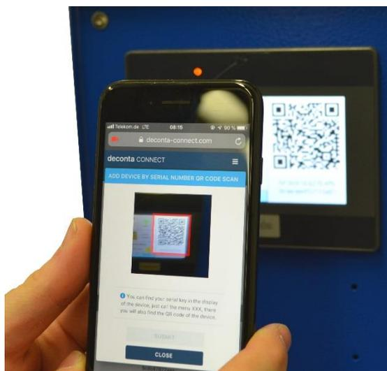
Scansionare il codice QR visualizzato sul display del dispositivo.
