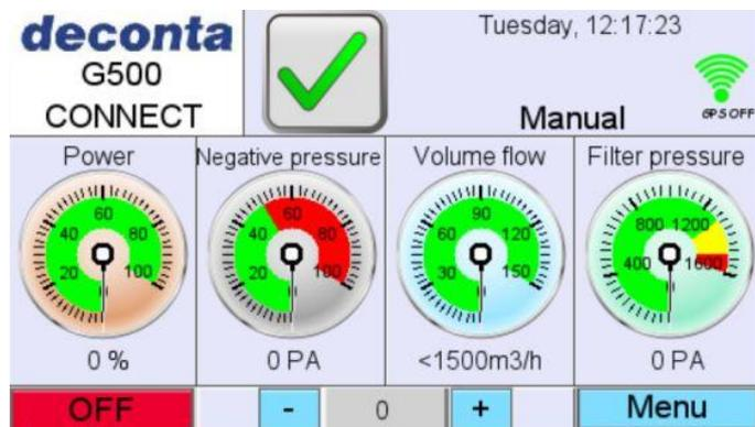
Pour surveiller le filtre, la pression du filtre (Filter pressure) s'affiche sur l'écran de la commande. Si l'affichage atteint la zone rouge, veuillez d'abord remplacer le préfiltre. Si la valeur affichée baisse de 100 pascals ou plus, l'appareil peut continuer à fonctionner. Si la valeur baisse de moins de 100 pascals, le filtre HEPA doit être remplacé.
