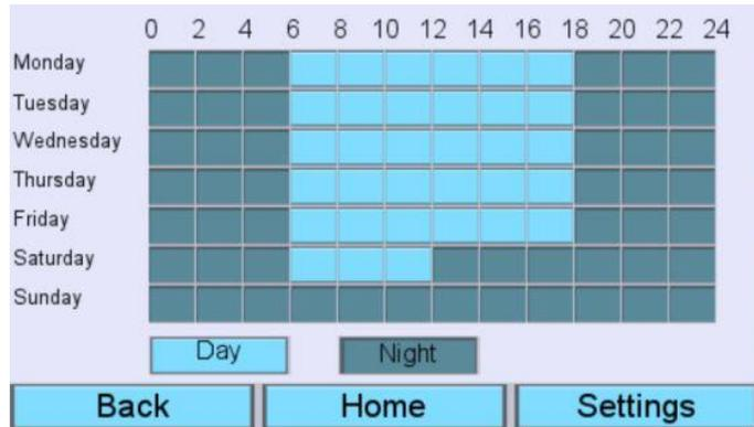
Durch Auswahl von Uhrzeitbereichen, kann hier eingestellt werden, an welchen Tagen und zu welcher Uhrzeit der im Automatik Betrieb eingestellte Wert für den minimaler Unterdruck im Nacht-Modus (min. negative pressure night) aktiviert ist.
