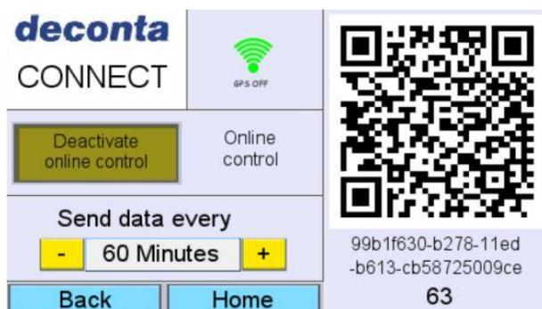
Die Seite mit einem QR-Code und darunter einem Key wird angezeigt.
