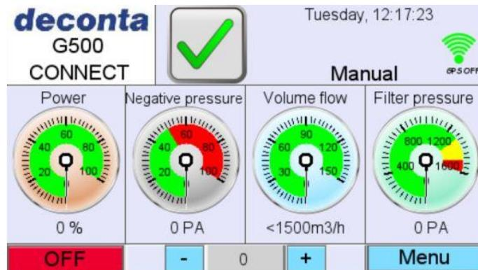
Zur Filterüberwachung wird der Filterdruck (Filter pressure) im Display der Steuerung abgebildet. Erreicht die Anzeige den roten Bereich, tauschen Sie bitte zuerst den Vorfilter. Sinkt der Anzeige-Wert um 100 Pascal oder mehr, kann das Gerät weiter betrieben werden. Sinkt der Wert um weniger als 100 Pascal, muss der HEPA-Filter erneuert werden.
