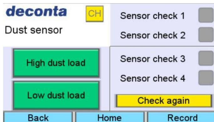
Die Messwerte der Filtersensoren können über den Button "Record" grafisch angezeigt werden.
