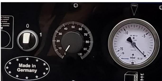
Der folgenden Tabelle können Sie die Anzeige-Werte für einen empfohlenen Filterwechsel entnehmen. Erreicht die Anzeige diesen Wert, tauschen Sie bitte zuerst den Vorfilter. Sinkt der Anzeige-Wert um 100 Pascal oder mehr, kann das Gerät weiter betrieben werden. Sinkt der Wert um weniger als 100 Pascal, muss der HEPA-Filter erneuert werden.
