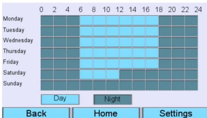
Selezionando gli intervalli di tempo, è possibile stabilire in quali giorni e in quali orari si attiva il valore impostato in modalità automatica per la pressione negativa minima in modalità notturna (pressione negativa minima notturna).
