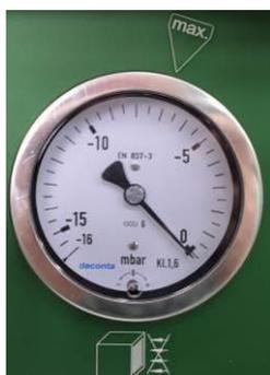
La tabella seguente mostra i valori del display per la sostituzione del filtro consigliata. Se il display raggiunge questo valore, sostituire prima i pre-filtri e i filtri intermedi. Se il valore visualizzato scende di 100 Pascal o più, l'unità può continuare a funzionare. Se il valore diminuisce di meno di 100 Pascal, è necessario sostituire il filtro HEPA.
