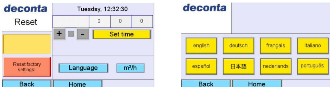
Durch Tippen auf den Button m<sup>3</sup>h kann die Einheit auf m<sup>3</sup>/min geändert werden.
