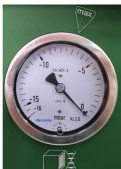
Der folgenden Tabelle können Sie die Anzeige-Werte für einen empfohlenen Filterwechsel entnehmen. Erreicht die Anzeige diesen Wert, tauschen Sie bitte zuerst die Vor- und Zwischenfilter. Sinkt der Anzeige-Wert um 100 Pascal oder mehr, kann das Gerät weiter betrieben werden. Sinkt der Wert um weniger als 100 Pascal, muss der HEPA-Filter erneuert werden.
