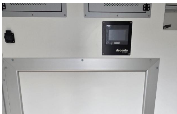
Abb. 18 Pantalla de control en la zona blanca
