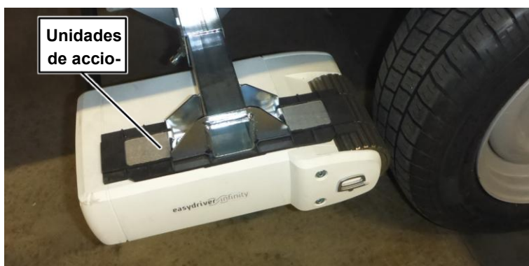
Abb. 14 Ayuda a la maniobra con unidad de accionamiento por rueda
