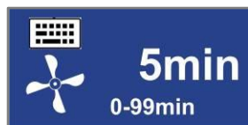
Abb. 57 Ajuste del tiempo de retardo del dispositivo de mantenimiento de la presión negativa
