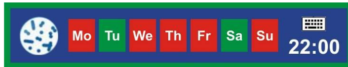
Abb. 65 Activación del programa de desinfección
