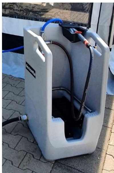
Abb. 9 Impianto di lavaggio stivali
