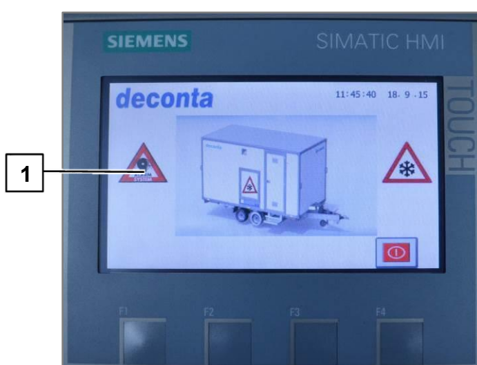
Abb. 78 Stato del sistema di allarme
