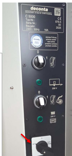
Abb. 3 Quadro elettrico con selettore «Rete / Alimentazione di emergenza»
