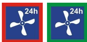
Abb. 56 Activation/désactivation du fonctionnement continu du dispositif de maintien de la dépression
