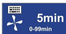
Abb. 57 Einstellung der Nachlaufzeit, für das Unterdruckhaltegerät
