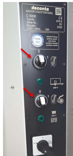
Abb. 10 Schalter „Zuwasser“ (oben) und Schalter „Abwasser“ (unten)
