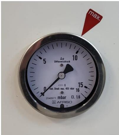
Der Wert für einen empfohlenen Filterwechsel ist mit einem roten Pfeil markiert.
