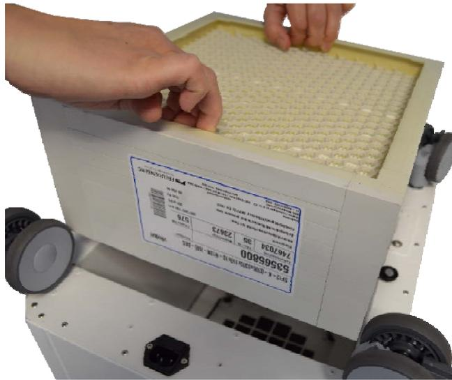
Abb. 29 HEPA-Filter entnehmen
