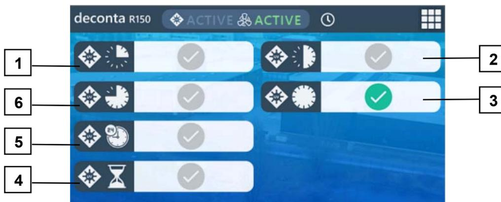
Abb. 12 Oberfläche zur Einstellung der UV-Lampen
