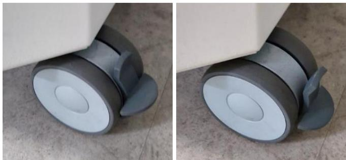
Abb. 6 Feststeller gelöst (links) und Feststeller betätigt (rechts)
