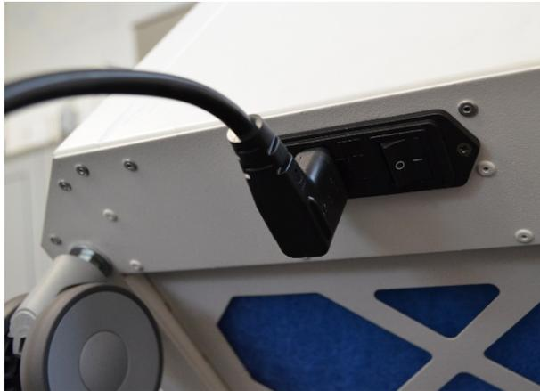
Abb. 1 Netzschalter
