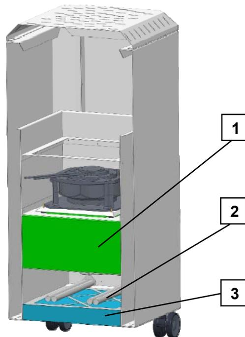
Abb. 2 Position von Filter und UV-Lampe (sofern verbaut)
