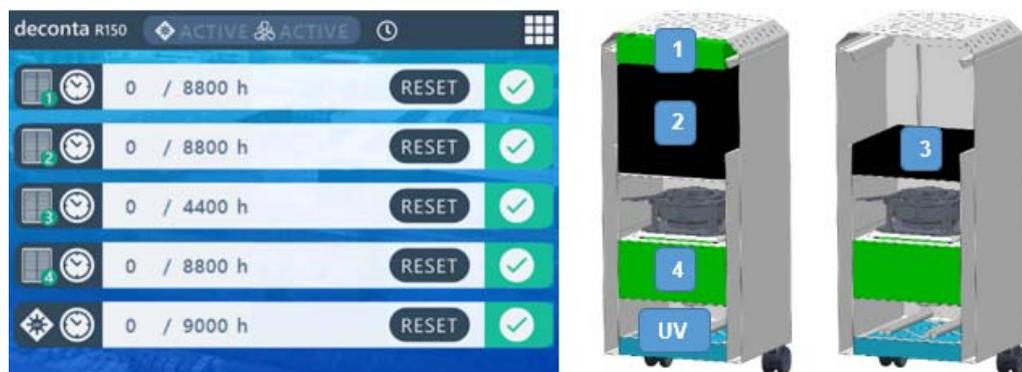
Abb. 14 Betriebsstunden und empfohlene Betriebszeit der einzelnen Stufen
