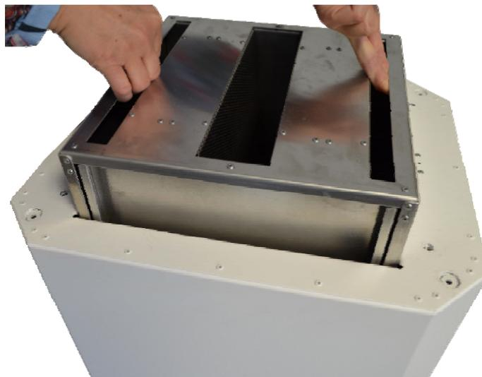
Abb. 34 Entnahme der Aktivkohlezelle
