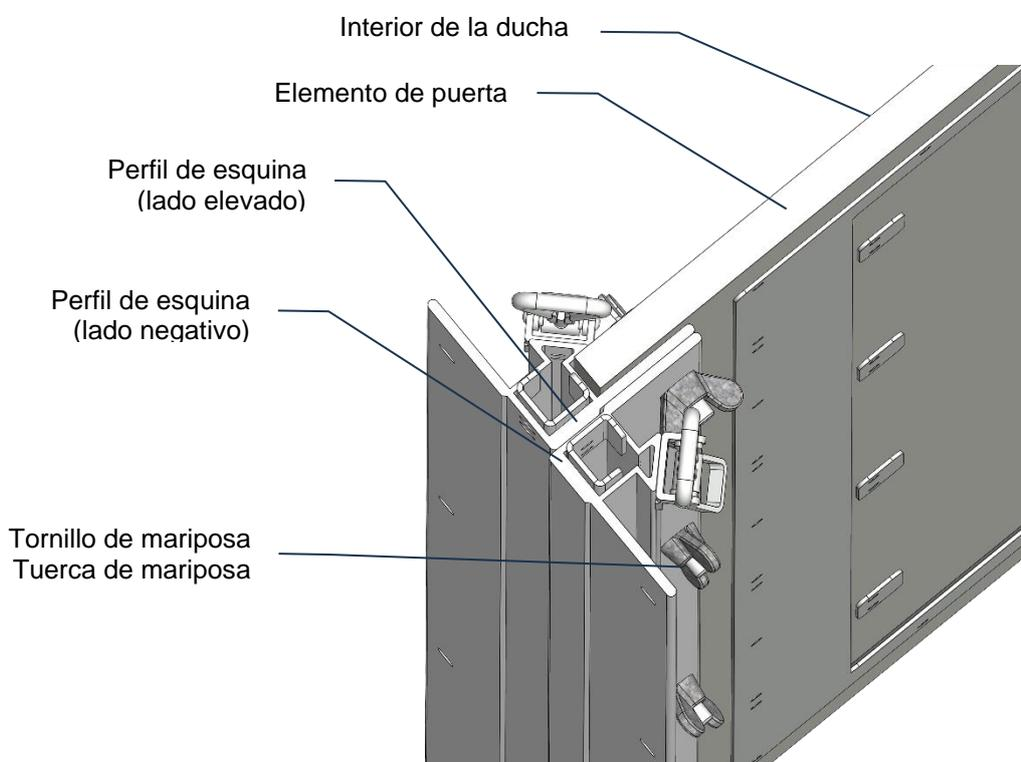
Coloque el elemento de puerta premontado en los soportes de montaje del elemento de suelo y sujételo a los elementos de suelo con los cierres rápidos fijados en los extremos de los perfiles angulares.
