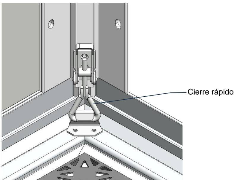
Inserte los elementos de pared en los ángulos de montaje del elemento de suelo y del perfil angular.
