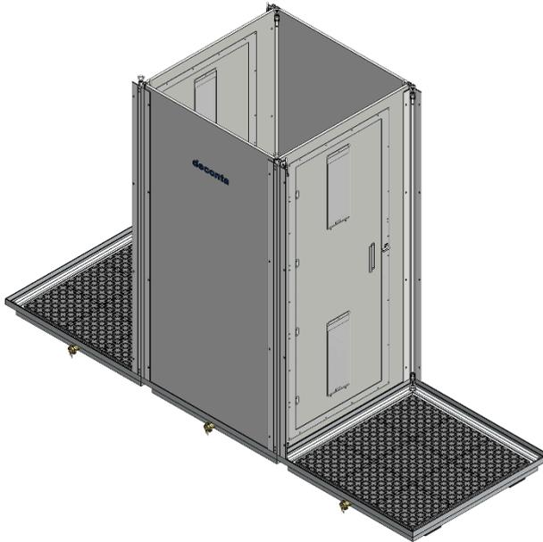
Das Dushdachelement mit Duschkabine aufsetzen und mit den Schnellspannverschlüssen verspannen.
