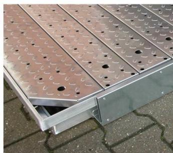
Insérer un profilé d'angle à l'angle de jonction de deux éléments de sol dans les équerres de réception et serrer les fermetures rapides fixées aux extrémités des profilés d'angle avec les éléments de sol.
