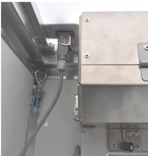
Raccorder les câbles électriques fournis aux trois raccords à l'extérieur du toit (où les fiches sont également raccordées de l'intérieur) et les relier à la commande de verrouillage forcé. L'ordre dans lequel les trois connecteurs sont raccordés à la commande n'a pas d'importance.
