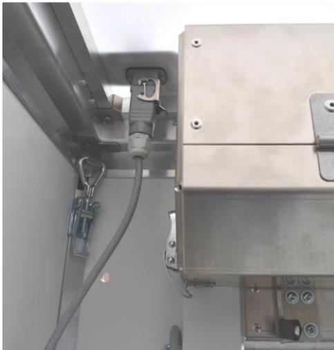
An den drei Anschlüssen außen am Dach (wo auch von innen die Stecker angeschlossen sind) die mitgelieferten Elektrokabel anschließen und mit der Steuerung Zwangsverriegelung verbinden. Dabei ist es egal, in welcher Reihenfolge die drei Stecker an die Steuerung angeschlossen werden.
