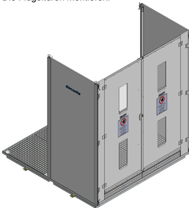
Die weiteren Wandelemente und Eckprofile montieren.
