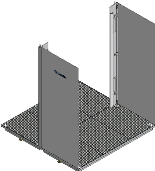
Führungszapfen des Rolltors in die Aufnahme der Rolltorführungen einsetzen.
