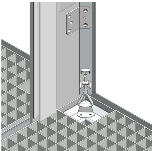
Wandelement in die Aufnahmewinkel des Bodenelements und des Eckprofils einsetzen.
