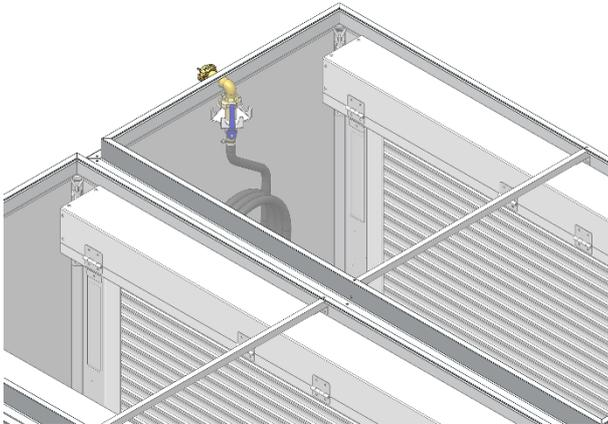
Dort, wo zwei Bodenelemente aneinander liegen, Verbindungsprofil auflegen. Dadurch wird ein Wasseraustritt aus der Schleuse verhindert.
