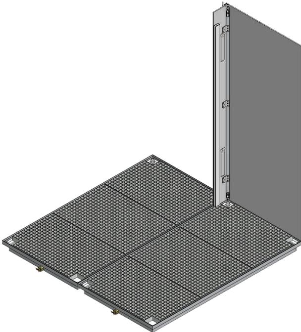
Eckprofil mit vormontierter Rolltorführung und Wandelement auf der gegenüberliegenden Seite montieren.
