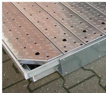
Ein Eckprofil an die Verbindungsecke zweier Bodenelemente in die Aufnahmewinkel einsetzen und die an den Enden der Eckprofile angebrachten Schnellspanverschlüsse mit den Bodenelementen verspannen.
