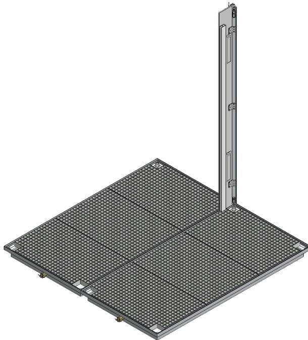
Ein Eckprofil mit vormontierter Rolltorführung an die Verbindungsecke zweier Bodenelemente in die Aufnahmewinkel einsetzen und die an den Enden der Eckprofile angebrachten Schnellspannverschlüsse mit den Bodenelementen verspannen.
