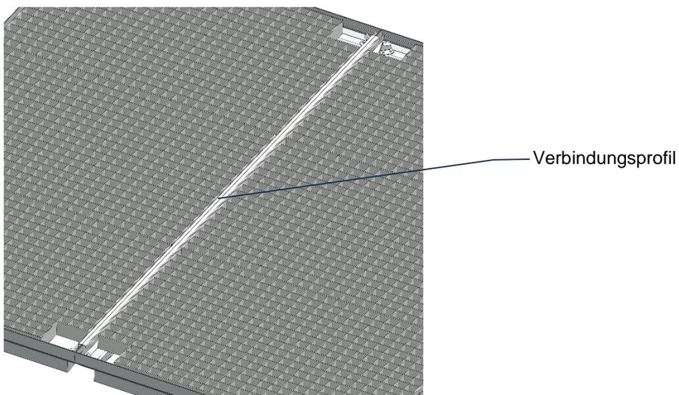
Um eine Beschädigung der Außenkanten zu verhindern, die Verstärkungsprofile montieren.
