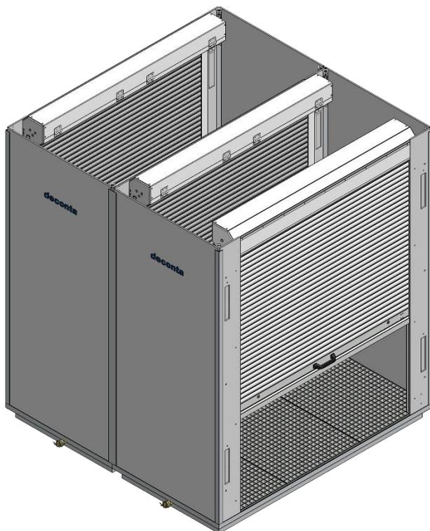
Die Dachelemente aufsetzen und jeweils mit den Spannverschlüssen in den 4 Ecken fixieren.
