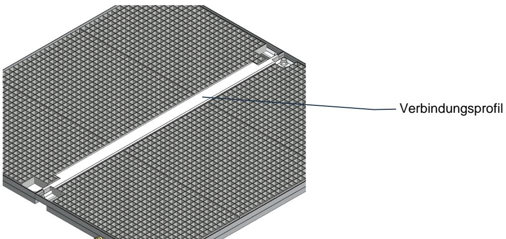
Um eine Beschädigung der Außenkanten zu verhindern, die Verstärkungsprofile montieren.
