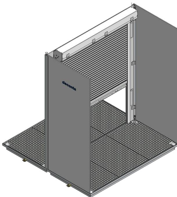
Die weiteren Wandelemente und die vormontierten Rolltorführungen montieren.
