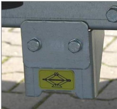
Abb. 11 Point d'attache pour le cric
