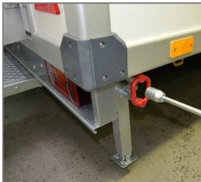
Abb. 16 Positionnement de la manivelle
