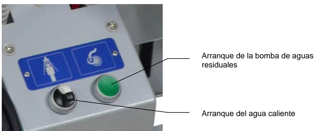
La bomba de aguas residuales puede encenderse manualmente manteniendo pulsado el interruptor "Arranque de la bomba de aguas residuales".
