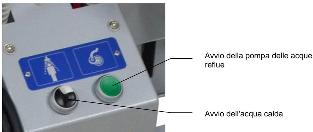
La pompa dell'acqua di scarico può essere attivata manualmente tenendo premuto l'interruttore "Avvio pompa acqua di scarico".
