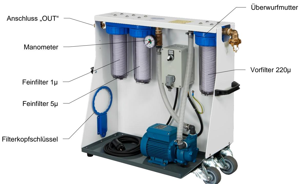
Die Feinfilter werden über das Manometer überwacht. Wir empfehlen einen Filterwechsel bei ca. 3bar.
