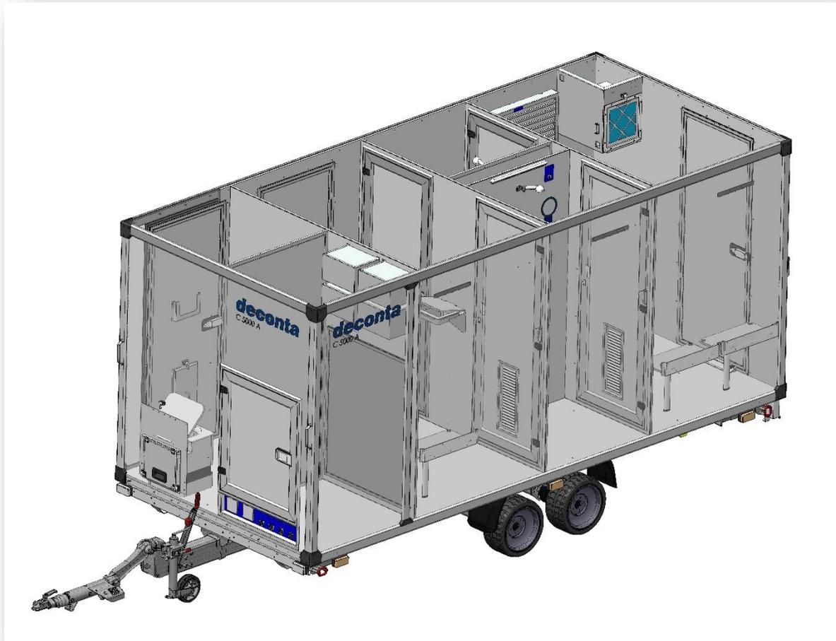
Das deco mobil C 5000 Veterinärwesen ermöglicht an Einsatzstellen eine schnelle und sichere Dekontamination von Personal und Geräten. Insbesondere bei der Tierseuchenbekämpfung muss in der Schutzzone eine Dekontamination der persönlichen Schutzausrüstung (PSA) sowie der mitgeführten Geräte erfolgen.
