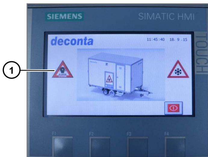
Fig. 67 Estado del dispositivo de alarma
