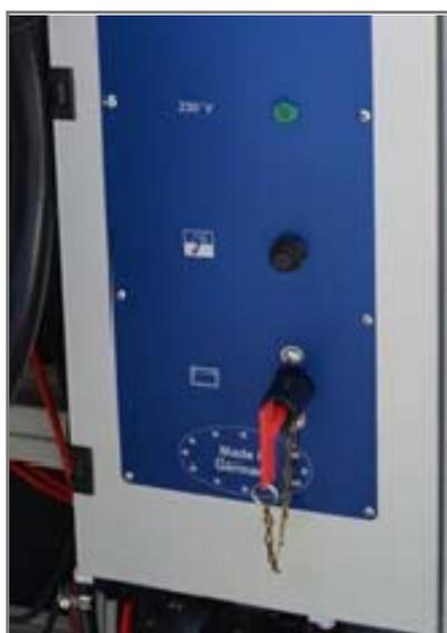
Fig. 17 Interruptor general de la batería
