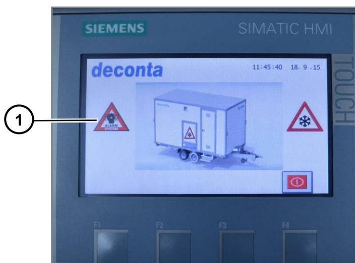
Fig. 100 Indicación del dispositivo de alarma
