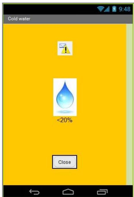
Fig. 120 Mensaje de advertencia, nivel de llenado del depósito de agua fría inferior al 20%
