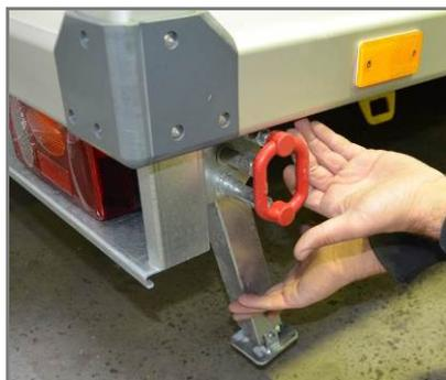
Fig. 26 Dispositivo de bloqueo
