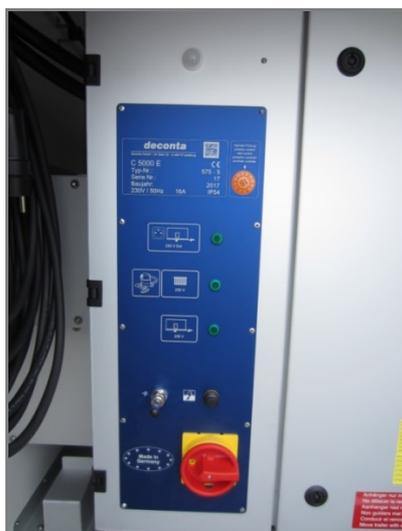
Fig. 16 Interruptor de parada de emergencia
