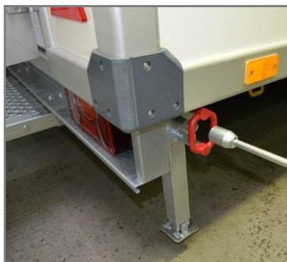
Fig. 27 Posicionamiento de la manivela
