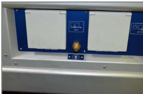
Fig. 124 Alimentación de aire comprimido
