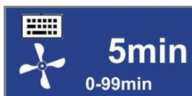
Fig. 46 Ajuste del tiempo del funcionamiento del aparato depresor después de que todas las personas hayan abandonado la esclusa
