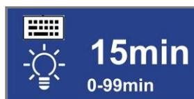
Fig. 83 Encendido/apagado del tiempo de marcha de inercia de la iluminación
