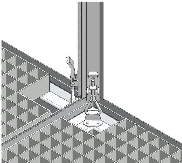
Inserte el elemento de pared en los soportes de montaje del elemento de suelo y el perfil angular.
