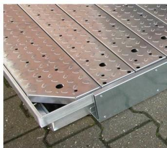
Inserte un perfil angular en la esquina de unión de dos elementos del suelo en los soportes de montaje y apriete los cierres rápidos fijados a los extremos de los perfiles angulares en los elementos del suelo.
