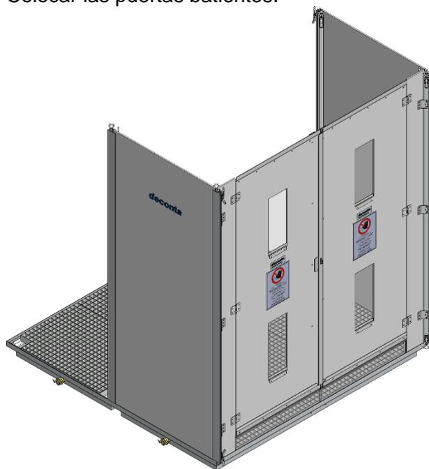
Instale los demás elementos de la pared y los perfiles angulares.
