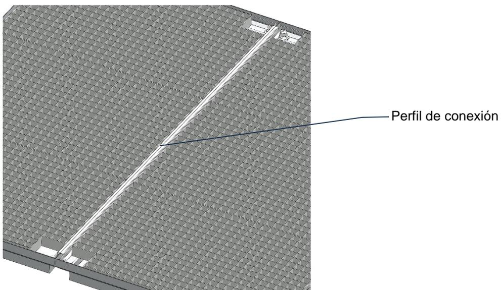
Para evitar daños en los bordes exteriores, coloque los perfiles de refuerzo.
