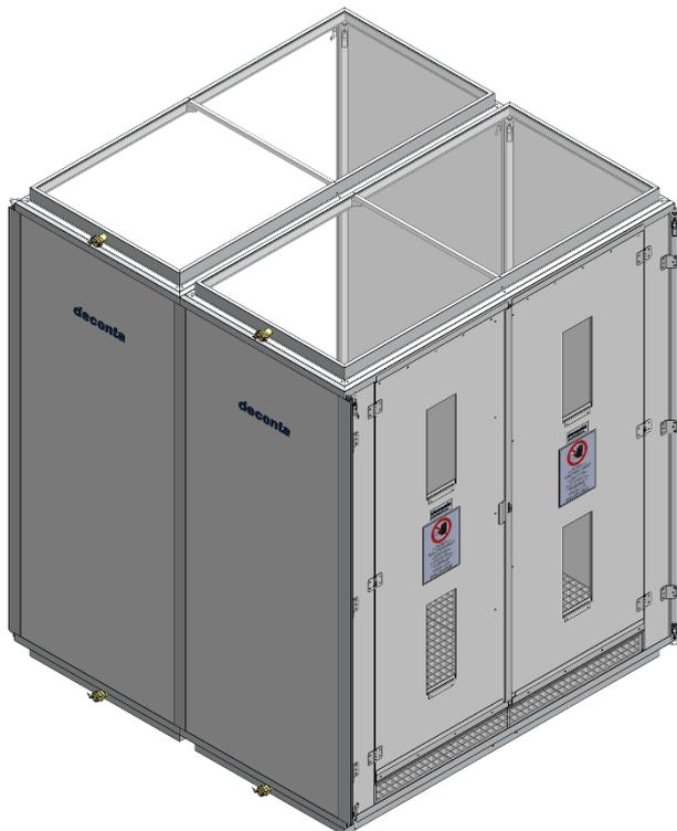
Coloque las cortinas de lamas ("flaps"). Se sujetan con tornillos de mariposa.
