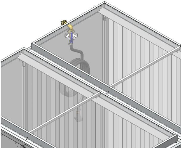
Là où deux éléments de sol sont placés l'un contre l'autre, poser un profilé de liaison. Cela permet d'éviter que l'eau ne s'échappe du sas.
