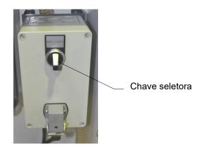
Ligue o equipamento (selecione a posição "Manual" na chave seletora) e controle o preenchimento da caixa do filtro com água
