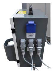
Schlüsselschalter an der Vorderseite der Steuerung auf Stellung "I" schalten. Die Steuerung der Zwangsverriegelung ist jetzt aktiv.
