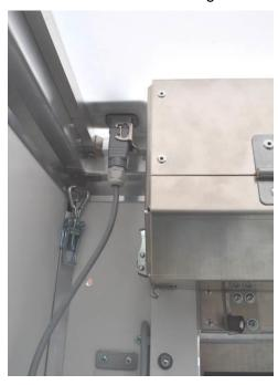
An den drei Anschlüssen außen am Dach (wo auch von innen die Stecker angeschlossen sind) die mitgelieferten Elektrokabel anschließen und mit der Steuerung Zwangsverriegelung verbinden. Dabei ist es egal, in welcher Reihenfolge die drei Stecker an die Steuerung angeschlossen werden.
